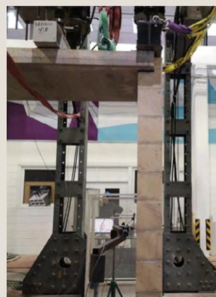
Réalisation de l'essai : chargement mécanique du mur de rive jusqu'à rupture
